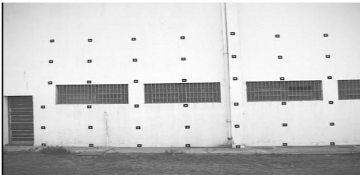
Com a UMMD posicionada estaticamente em três perspectivas diferentes, foram adquiridos três pares de imagens dos alvos na parede, um par para cada ponto de vista. Esta configuração foi usada a fim de contribuir para a minimização da correlação entre alguns parâmetros de orientação interior e exterior. Como pode-se ver na Figura 05, estas perspectivas são: oblíqua à esquerda, frontal e oblíqua à direita.
