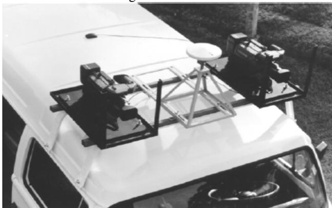
O comprimento da estéreo-base, como mencionado, será utilizado como inunção no processo de fototriangulação para orientação das imagens (SILVA et
