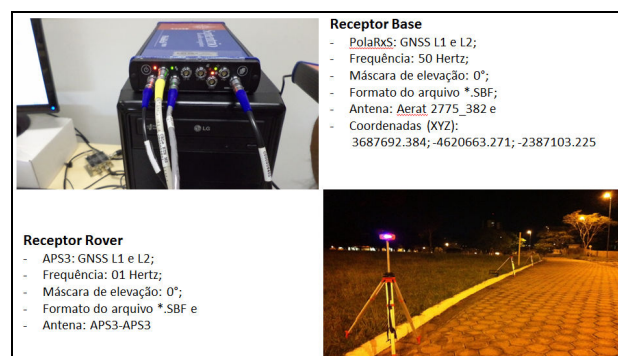
Figura 2 – Configuração do Experimento mostrando as estações Base e Rover.
