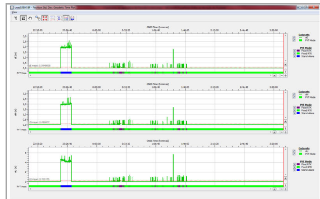
Figura 5 – Precisão das componentes N, E e U para a solução em tempo real (RTK).
