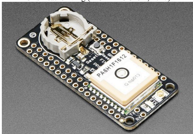
Imagem 1 – Equipamento utilizado: Adafruit Ultimate GPS FeatherWing (MULTILÓGICA, 2017)
